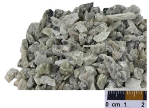
Gros plan du concentré de spodumène (DMS + fractions non magnétiques) 5,8 %  $\text{Li}_2\text{O}$  et 0,60 %  $\text{Fe}_2\text{O}_3$  à 79 % de récupération.
